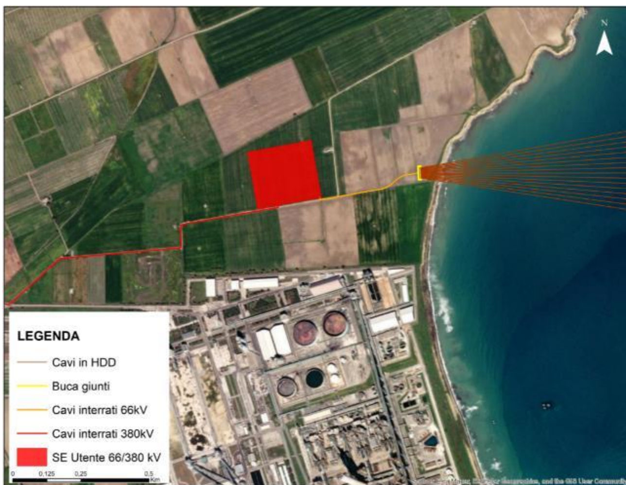
Figura 23: Inquadramento su ortofoto della Stazione Elettrica Kailia Lato Utente.
