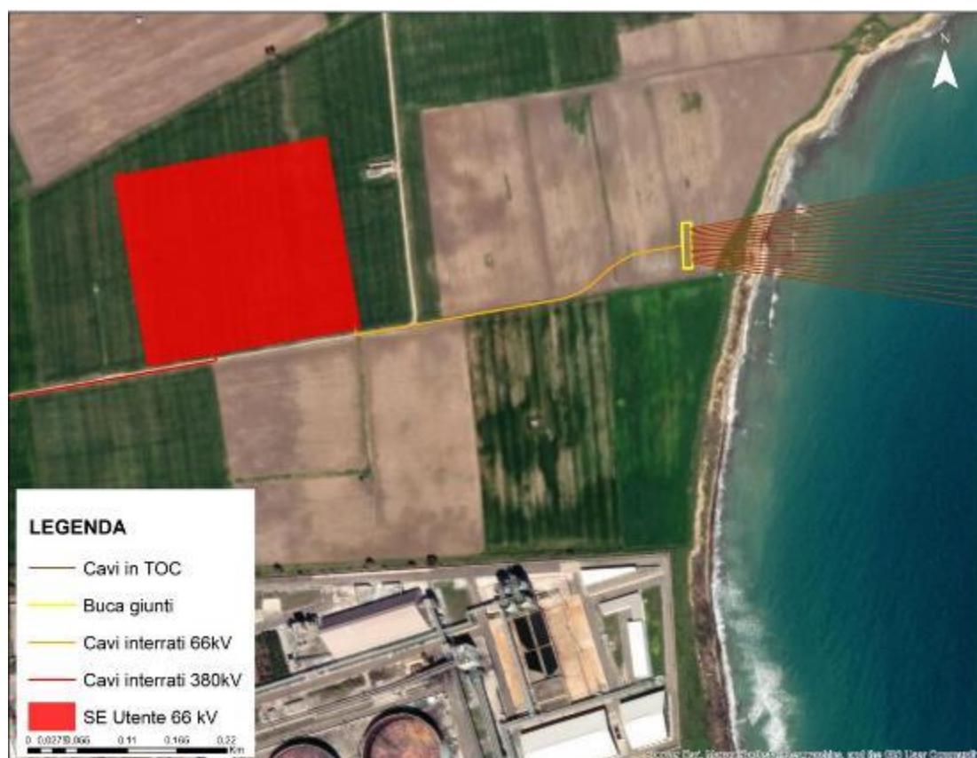
Figura 18: Cavo interrato di connessione 66 kV tra la buca giunti e la SE Utente 66/380 kV.
