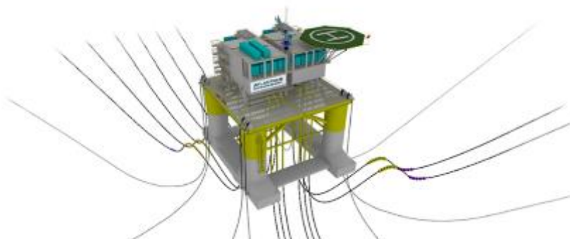
Figura 8: Esempio di sottostazione galleggiante (semi-sommersibile in questo esempio).
