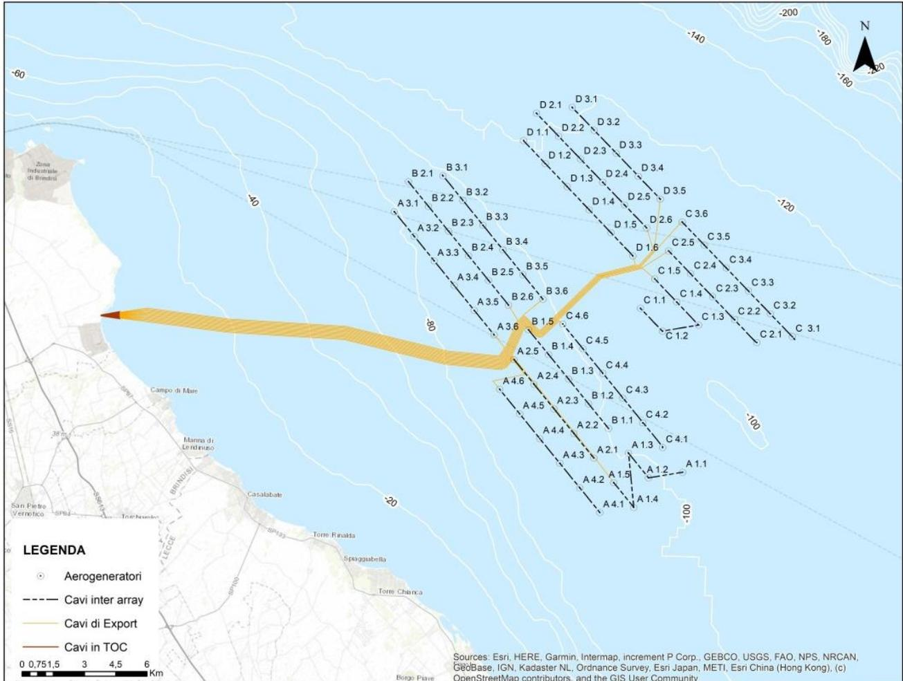
Nota: il progetto prevede la posa di 14 cavi di export disposti a circa 50 m di distanza. Alla scala di rappresentazione i singoli cavi non sono visibili.
