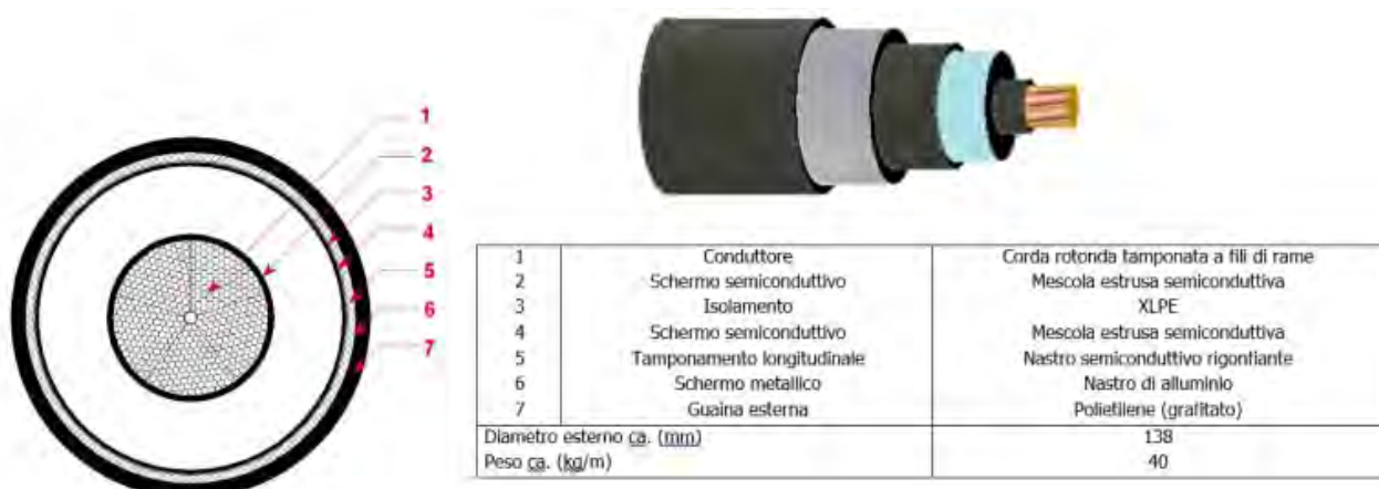
Figura 18: Sezione indicativa del cavo che verrà utilizzato.
