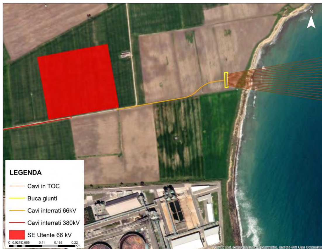
Figura 7: Cavidotto interrato di connessione 66 kV tra la buca giunti e la SE Utente 66/380 kV.
