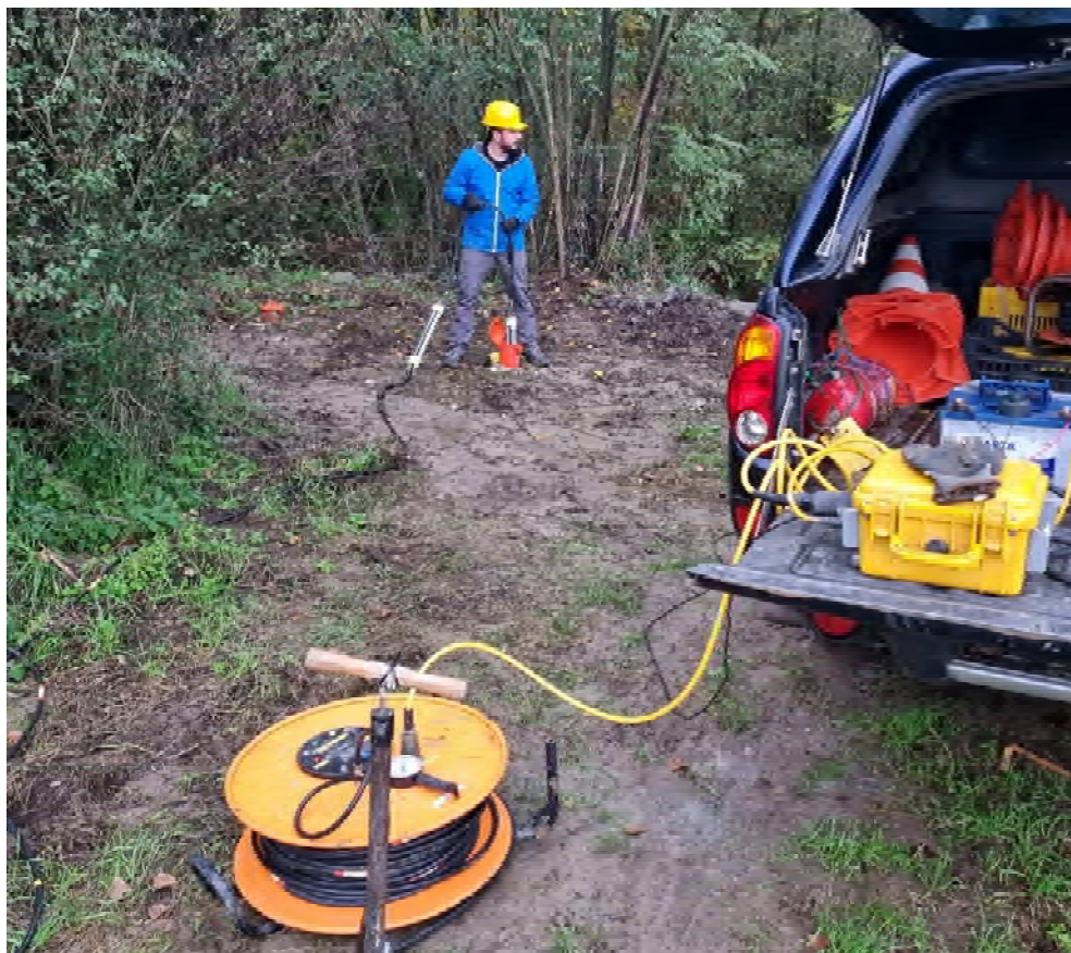
Inserimento della doppia terna di sensori nel foro SN_DH02
