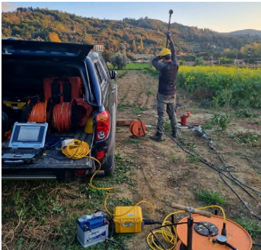
Esecuzione indagine sismica in foro Down Hole SN20_DH
