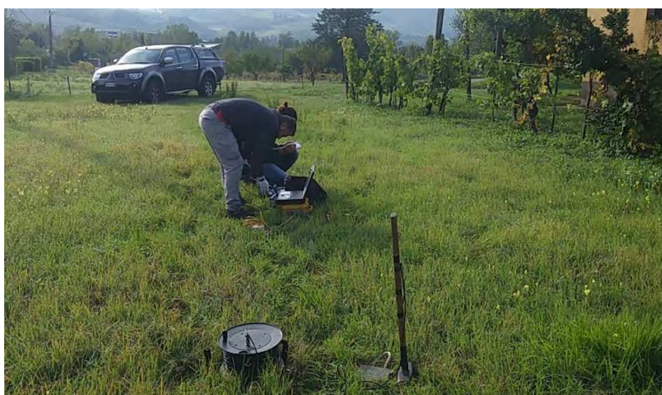
Esecuzione indagine in foro SN09_DH e a rifrazione N02
