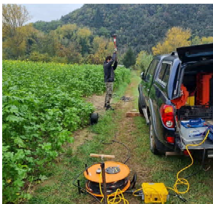
Esecuzione indagine sismica in foro Down Hole SN18_DH
