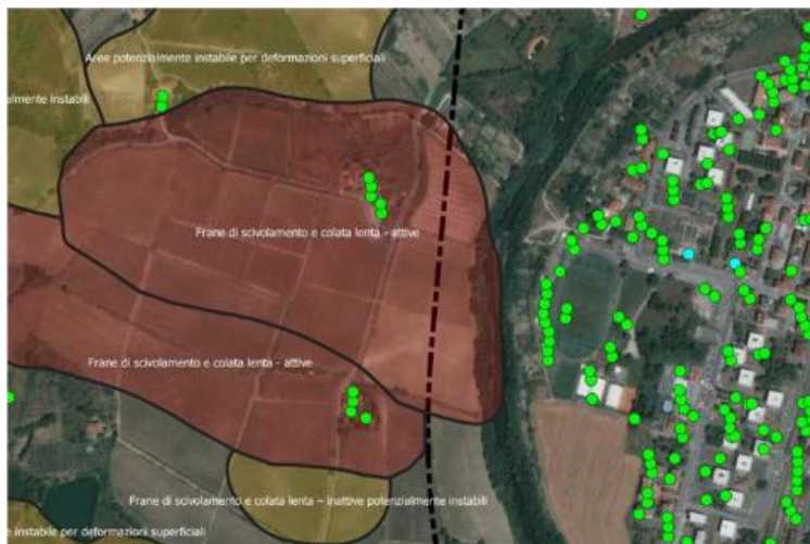
Figura 10-2 – Distribuzione dei PS e relativi valori di velocità nell'areale della frana di scivolamento e colata lenta attiva (S3) e pericolosità geomorfologica molto elevata (P4) - traiettoria ascendente
