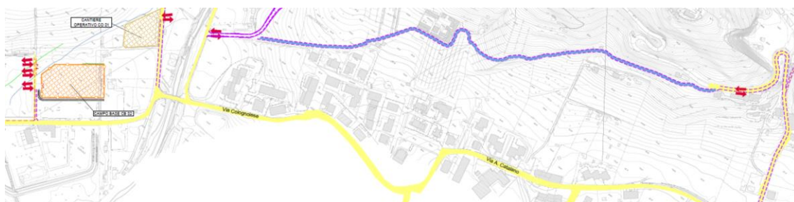
Planimetria viabilità esistente da riqualificare per accesso area di supporto viadotto Argomenna, viadotto Sieve 2 e realizzazione galleria Montebonello
