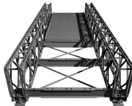
Viste schematiche indicative di un ponte tipo Bailey MK DS.
