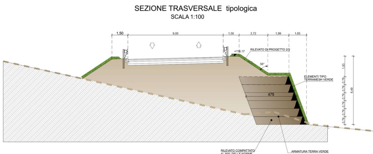
*Schematizzazione tipologica sistema tipo terramesh*
