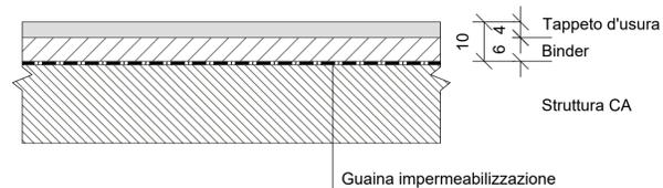
DETTAGLIO 5 - PARTICOLARE PACCHETTO DI PAVIMENTAZIONE GALLERIA- scala 1:10
