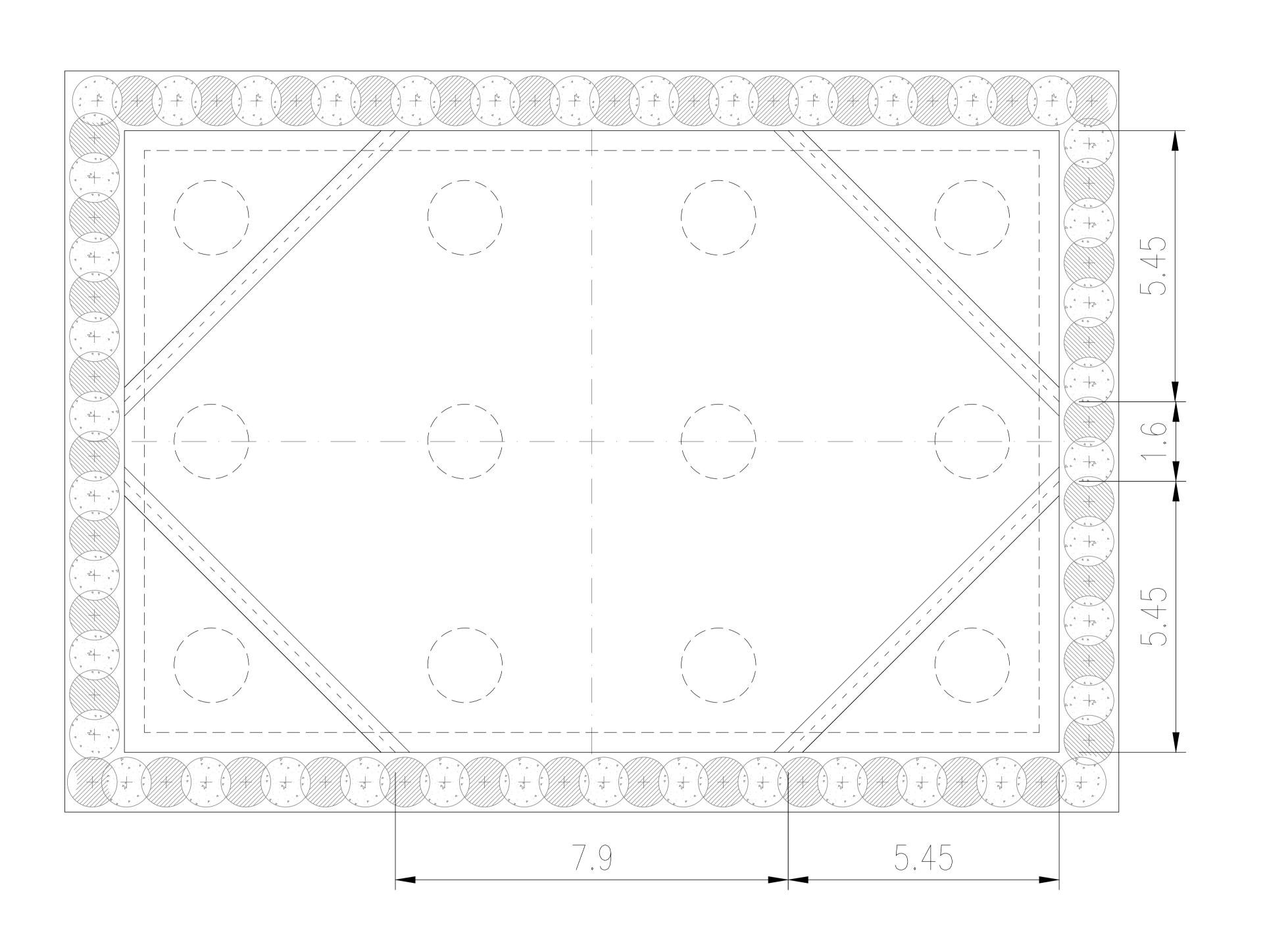
Puntoni provvisori D=406mm -SP=10mm Acciaio S355 N.B.\_PUNTONI APPLICATI A TUTTE LE PILE SULLA TRAVE IN C.A
