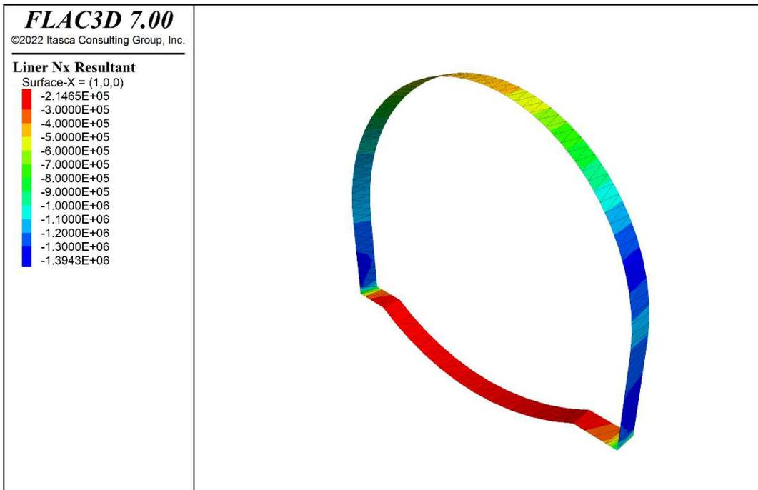
**Figura 112 - Sezione GN-B1 – Azione assiale nel rivestimento definitivo [N] (step 6)**
