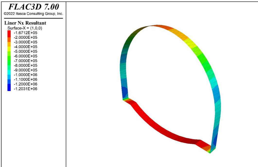
**Figura 81 - Sezione GN-A2 – Azione assiale nel rivestimento definitivo [N] (step 6)**
