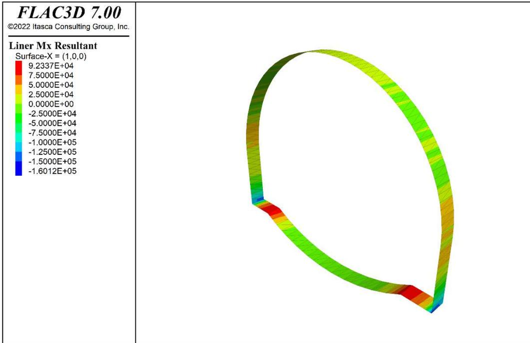
**Figura 82 - Sezione GN-A2 – Momento nel rivestimento definitivo [Nm] (step 6)**
