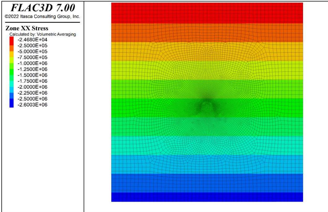
**Figura 95 - Sezione GN-B1 - Geostatico (sforzi orizzontali)**
