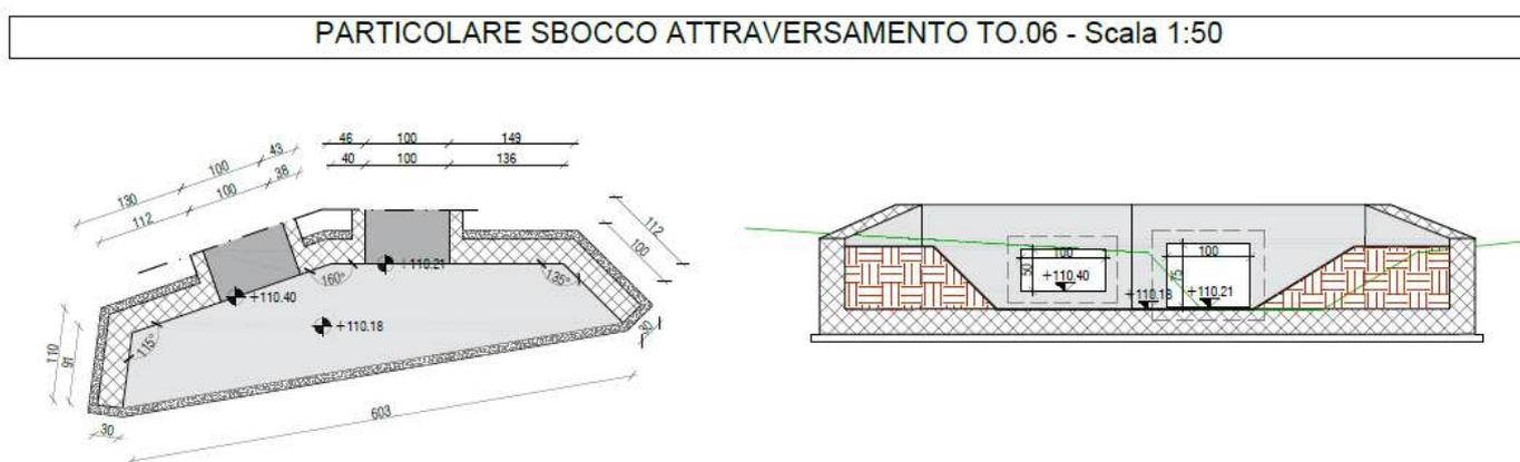
**Figura 2: carpenterie elementi di sbocco**
