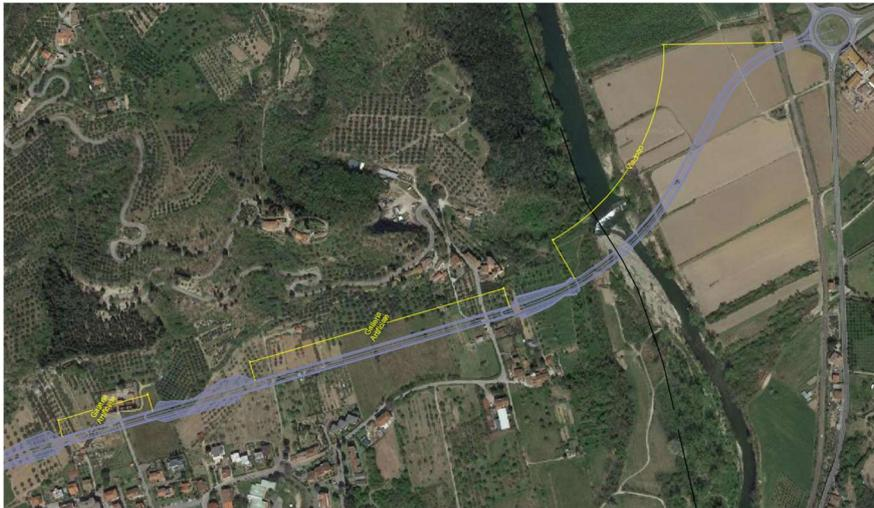
Successivamente il tracciato attraversa il torrente Argomenna con viadotto lungo 191 m. per connettersi, in rilevato, si via Colognolese mediante rotatoria a raso.
