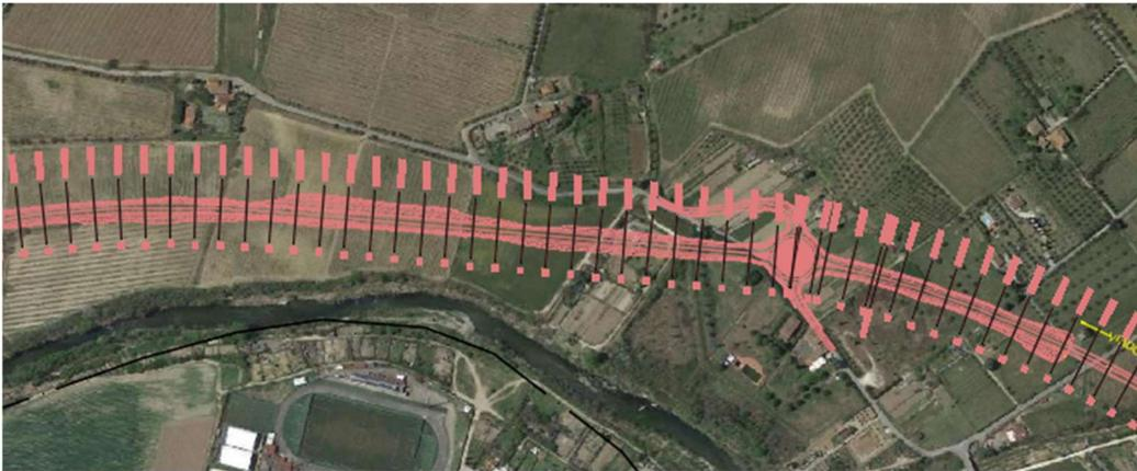
Il tracciato prosegue in rilevato costeggiando il fiume in destra orografica per circa 1,5 km. Il tracciato si riporta in sinistra orografica per riconnettersi alla SS67 mediante rotatoria a raso attraversando il fiume Sieve con viadotto di 400 metri di lunghezza.
