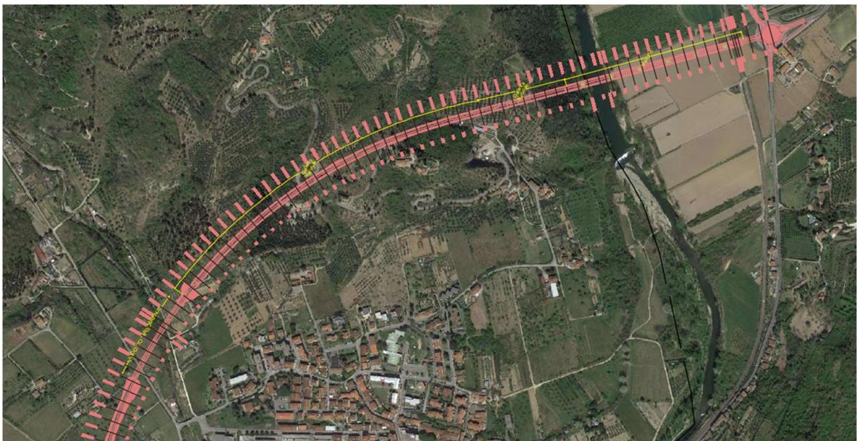
Uscendo in viadotto (198 m. di lunghezza) per attraversare il torrente Argomenna, si riconnette in rilevato su via Colognese mediante rotatoria a raso.
