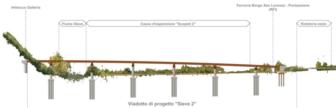
Prospetto tipologico Viadotto Sieve 2 ad alta quota
