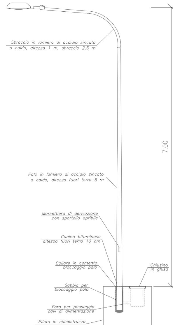
TIPOLOGICO DI INSTALLAZIONE PALO COMPLETO DI PLINTO DI FONDAZIONE
