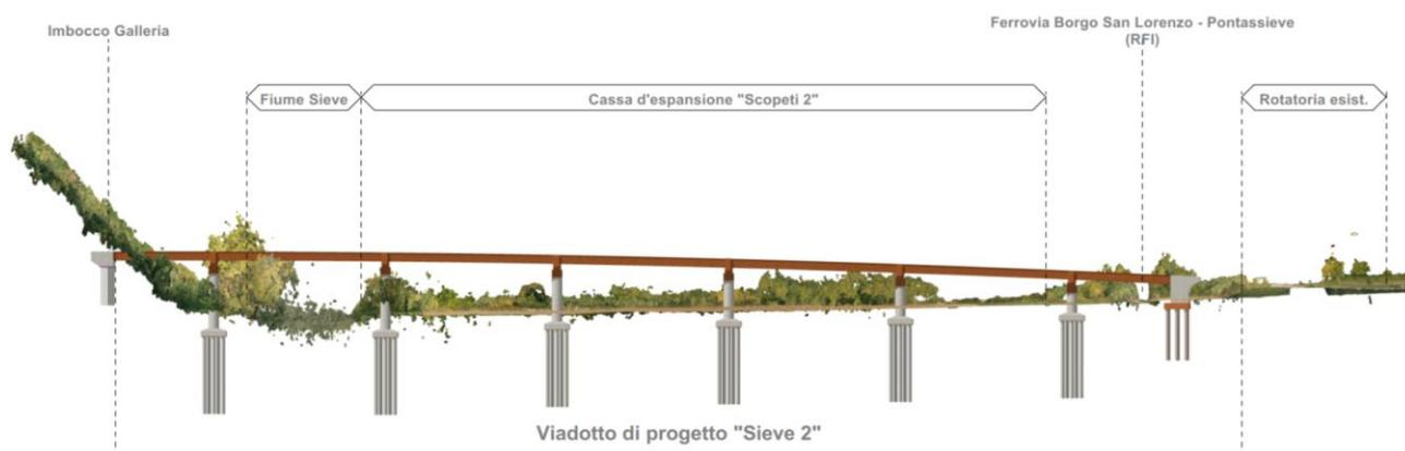
**Prospetto tipologico Viadotto Sieve 2 ad alta quota**
