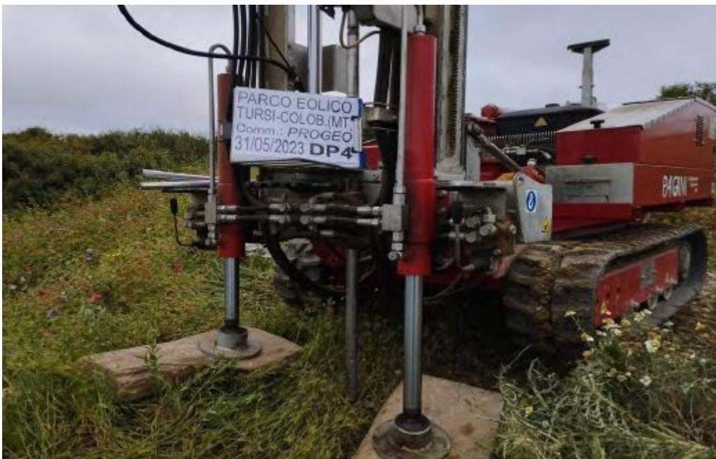
La prova DPSH5, effettuata nelle vicinanze dell'aerogeneratore CT\_10, ha raggiunto la profondità massima di 3,2 metri dal p.c.
