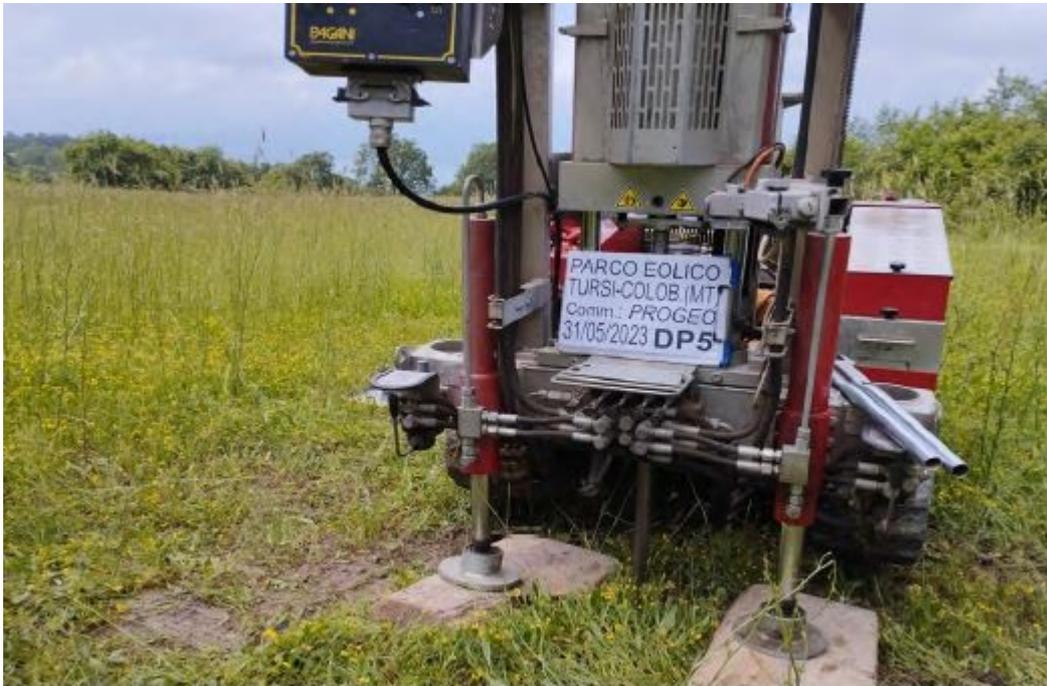
Tali prove sono state effettuate utilizzando un penetrometro PAGANI modello TG 63-200; la prova penetrometrica dinamica consiste nell'infiggere nel terreno una punta conica (*per tratti consecutivi "d"*) misurando il numero di colpi N necessari.
