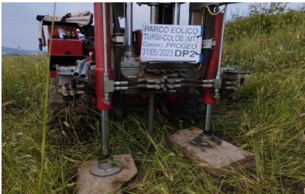
La prova DPSH3, effettuata nelle vicinanze dell'aerogeneratore CT\_07, ha raggiunto la profondità massima di 3,2 metri dal p.c.
