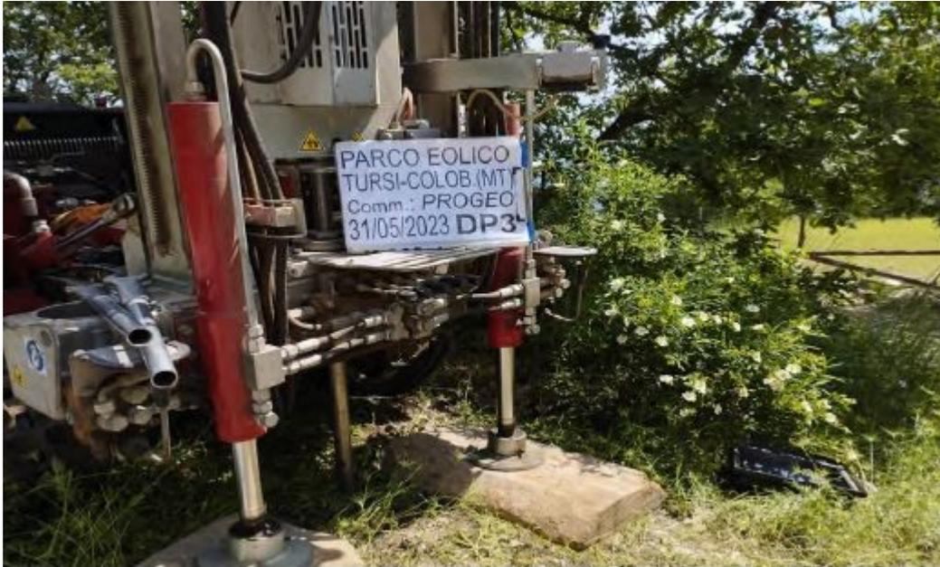
La prova DPSH4, effettuata nelle vicinanze dell'aerogeneratore CT\_05, ha raggiunto la profondità massima di 3,8 metri dal p.c.
