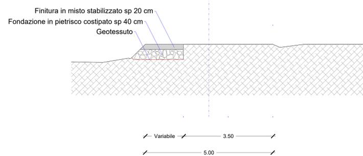
SEZIONE TIPO-ADEGUAMENTO VIABILITA' ESISTENTE\_SCALA 1:50
