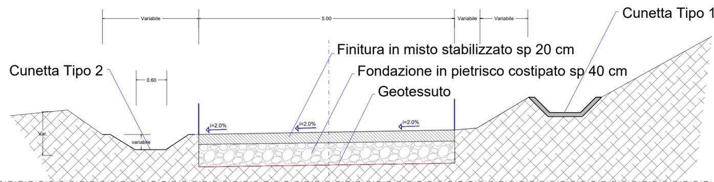
**SEZIONE TIPO MANUFATTO IMBOCCO/SBOCCO ATTRAVERSAMENTO STRADALE**
