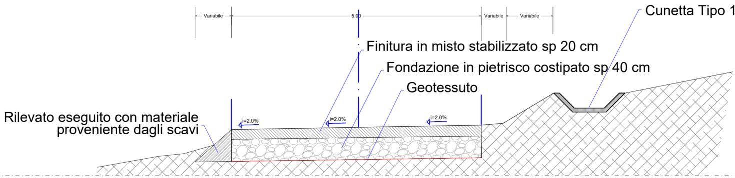
**SEZIONE TIPO CON DRENAGGIO A MONTE E A VALLE**
