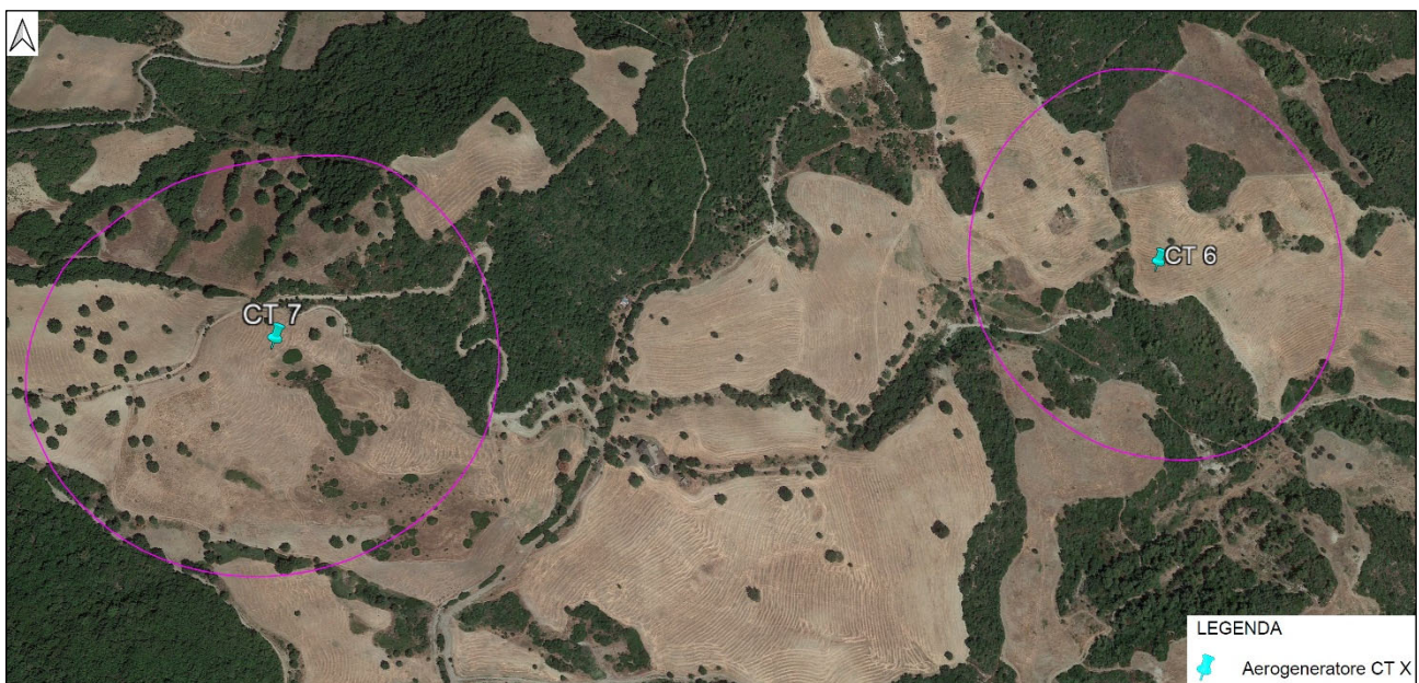
Figura 10.2: Aree interessate dalla rottura della pala relativamente agli aerogeneratori CT 6 e CT 7 su immagine satellitare
