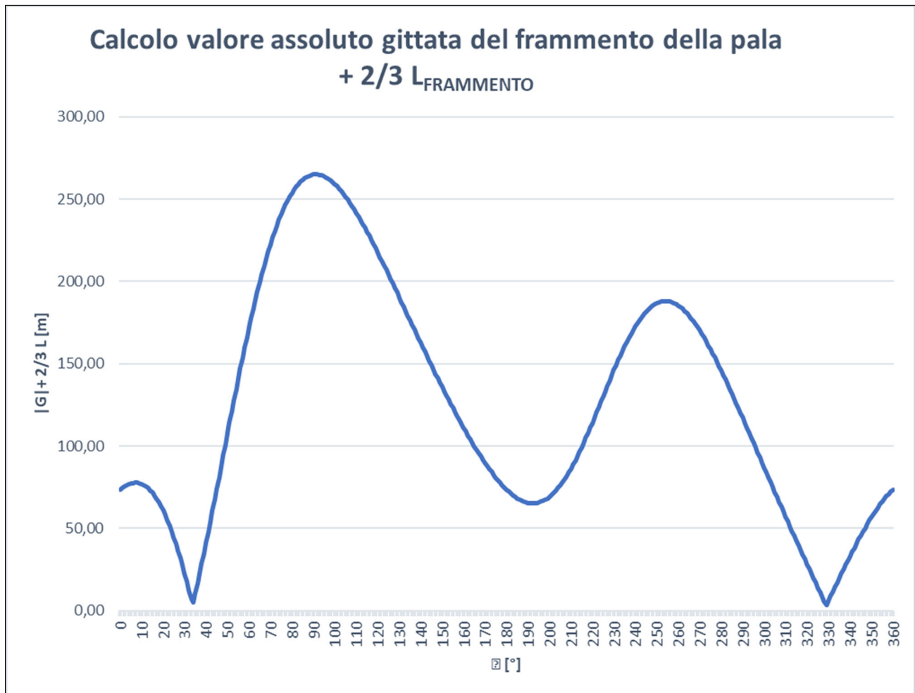
Figura 9.2: Grafico del valore assoluto della gittata del frammento della pala di lunghezza 5 \text{ m} + \frac{2}{3} L_{\text{FRAMMENTO}}
