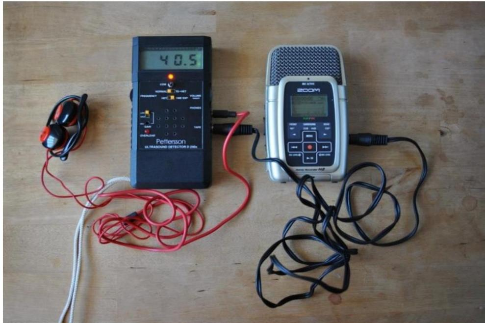
Figura 7-19: Strumentazione per i rilievi ultrasonori manuali: a sinistra bat detector D240 X Pettersson Elektronik, a destra Registratore Digitale Zoom H2.
