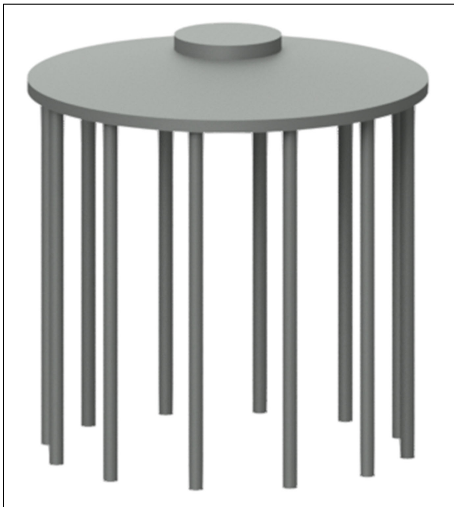
Figura 5: vista tridimensionale della fondazione dell'aerogeneratore
