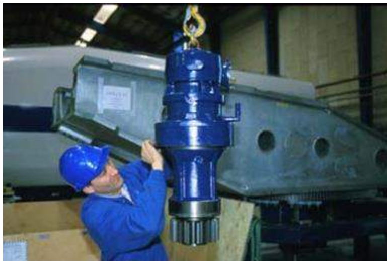
Figura 13: motori di giro e riduttori
