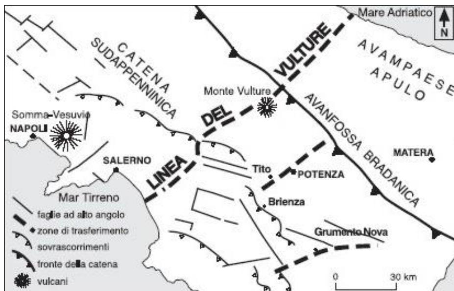
**Figura 4 - Schema tettonico semplificato dell'Appennino meridionale. Si noti il fascio di trasferimento strutturale qui denominato Linea del Vulture (Schiattarella et al., 2005).**
