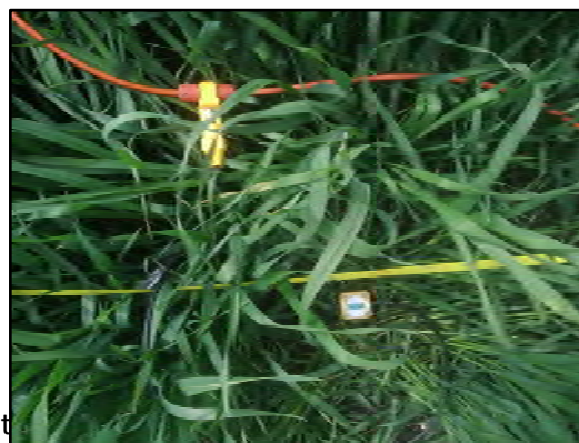
Fotografia 16 Determinazione del valore medio di velocità delle onde di compressione
