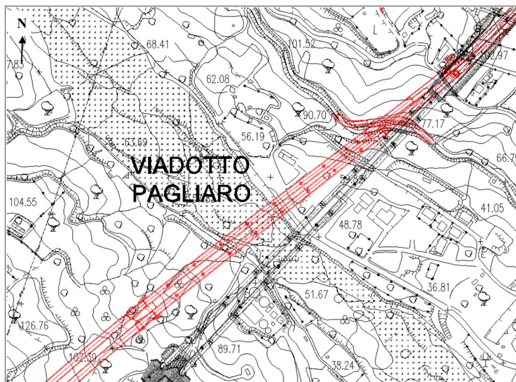
Nel PP il viadotto dal km 22+313 si sviluppava per m 522 circa. La variante prevede lo spostamento del tracciato ad una distanza di circa 100 m verso mare, il restringimento delle due carreggiate ed un aumento delle luci del viadotto. Conseguirà inoltre l'eliminazione della complessa deviazione stradale in quanto la viabilità secondaria esistente non è più interessata dall'interferenza con il tracciato.
