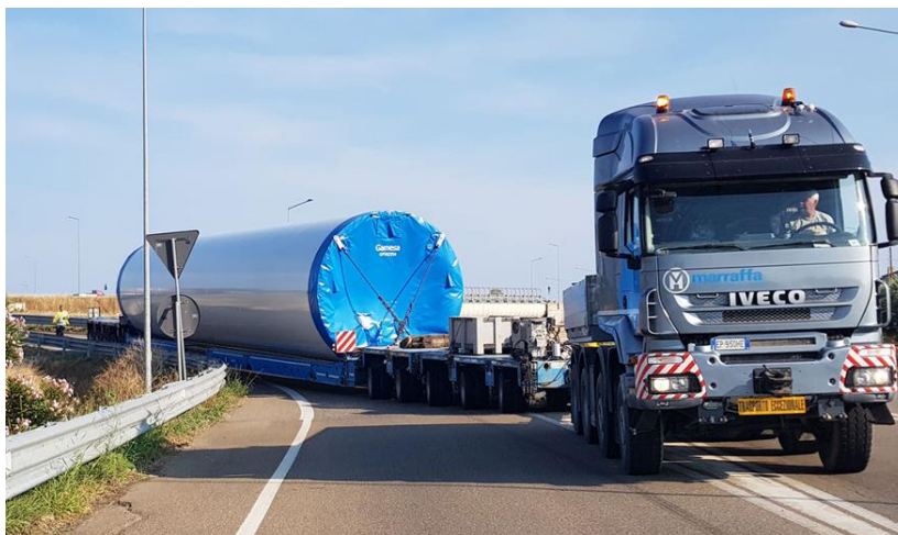
Figura 77 – Trasporto tronco di torre eolica.
