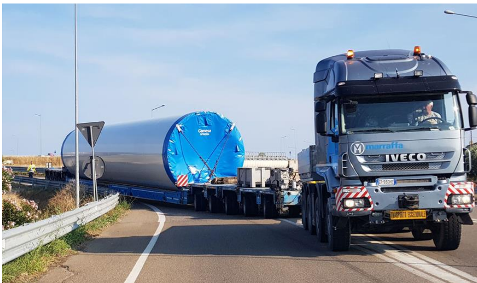
Figura 2—41 – Trasporto tronco di torre eolica.
