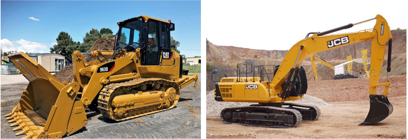
Figura 2—42 – A sx pala cingolata, a dx escavatore cingolato.
