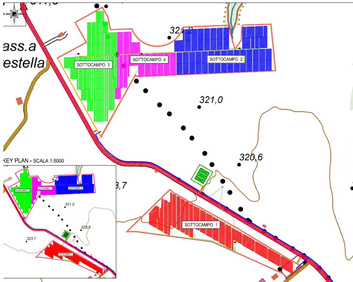
Figura 19: Planimetria dell'impianto con definizione dei sottocampi
