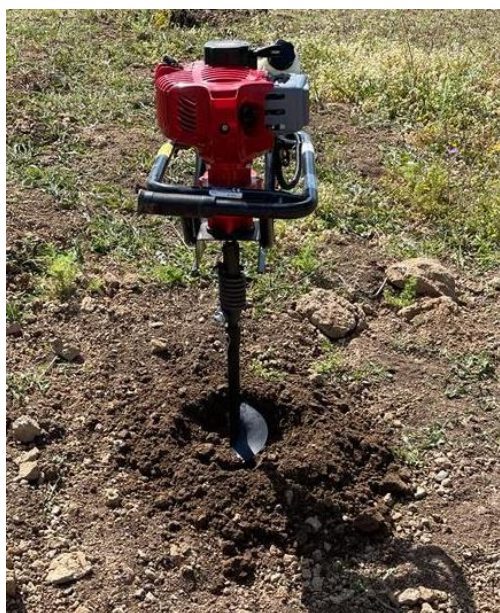
Mototrivella Valex Auger 52F5 utilizzata per il campionamento
