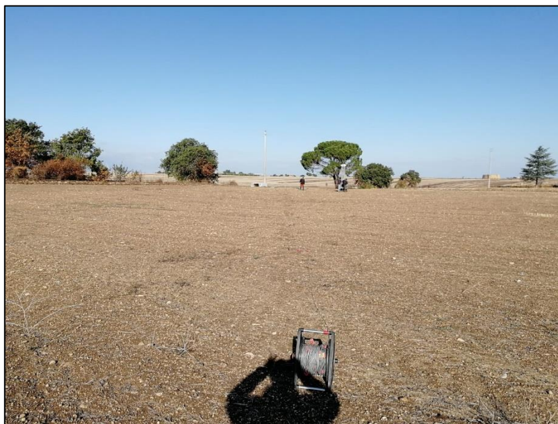
Fig.03: Prova geofisica MASW eseguita nell'area prevista per l'installazione dei pannelli fotovoltaici
