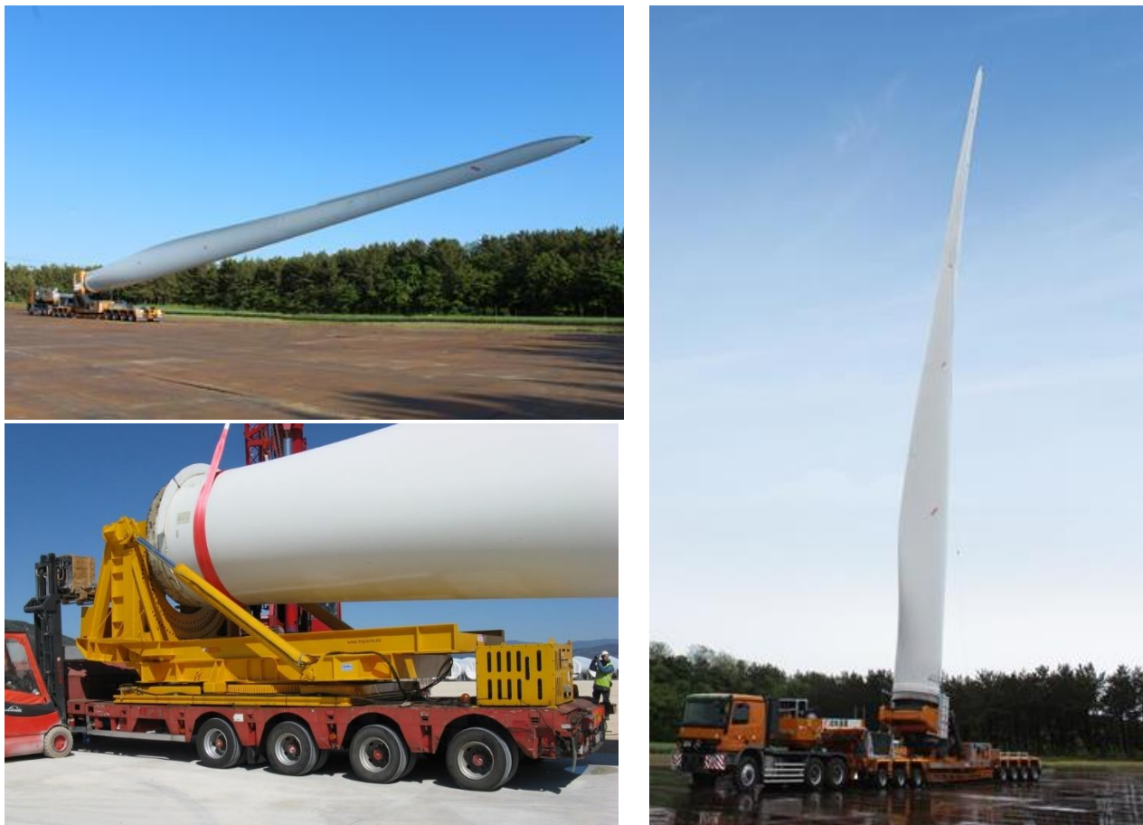
Figura 11 – Trasporto con blade lifter (fonte: https://www.faymonville.com/tecnologie/bladelifter-il-blademax/ ).
