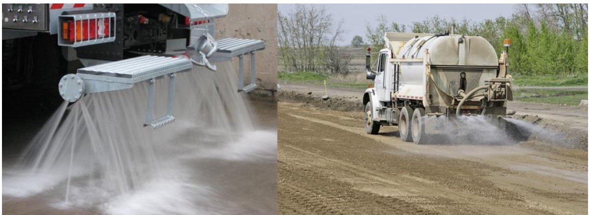
Figura 8-23: Automezzo per la bagnatura delle piste sterrate
