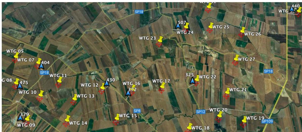
In questo caso remoto, di rottura a 5 metri dalla punta della pala, gli aerogeneratori rispettano le distanze di sicurezza con eccezione degli aerogeneratori **WTG9**, **WTG16** e **WTG22**.
