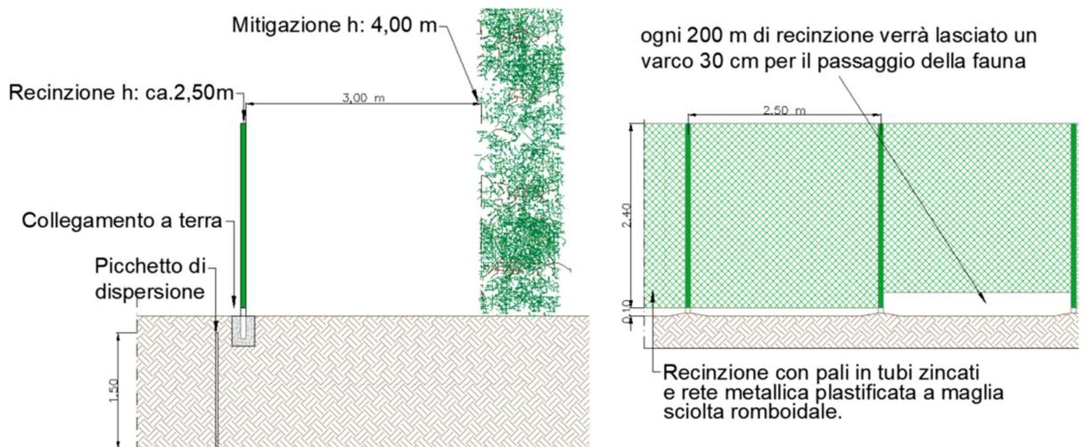
Figura 10 - Rappresentazione della recinzione prevista di altezza pari a 2.5m
