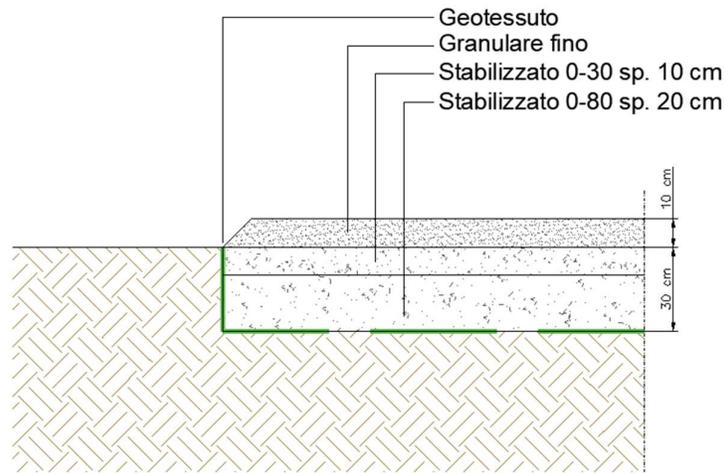
Figura 9 - Sezione tipo viabilità interna all'impianto e piazzali
