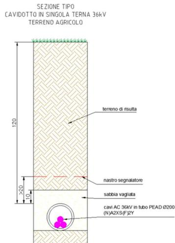
Figura 6 - Sezioni tipo 36 kV
