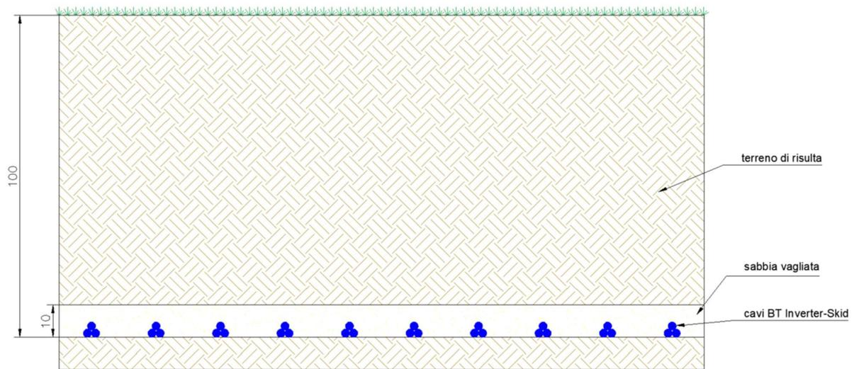
Figura 5 - Sezioni tipo inverter - Skid
