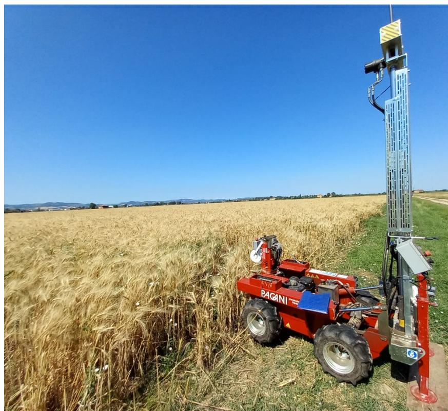
**Figura 11: Escuzione prova penetrometrica P1**
