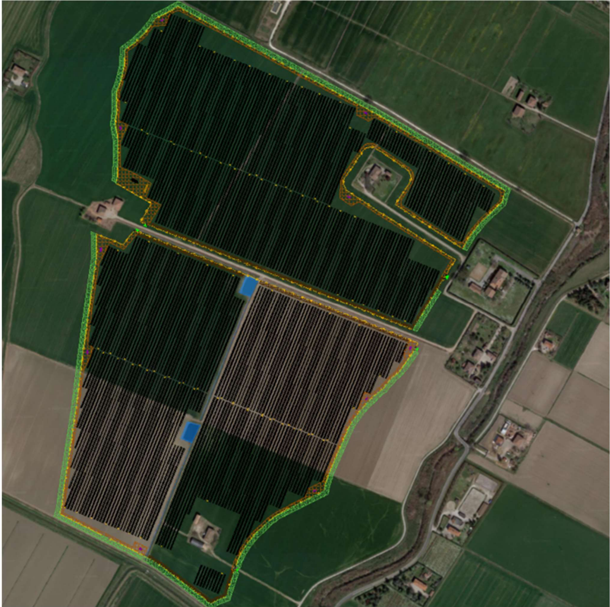
Figura 1 - Layout campo Nord dell'impianto fotovoltaico
