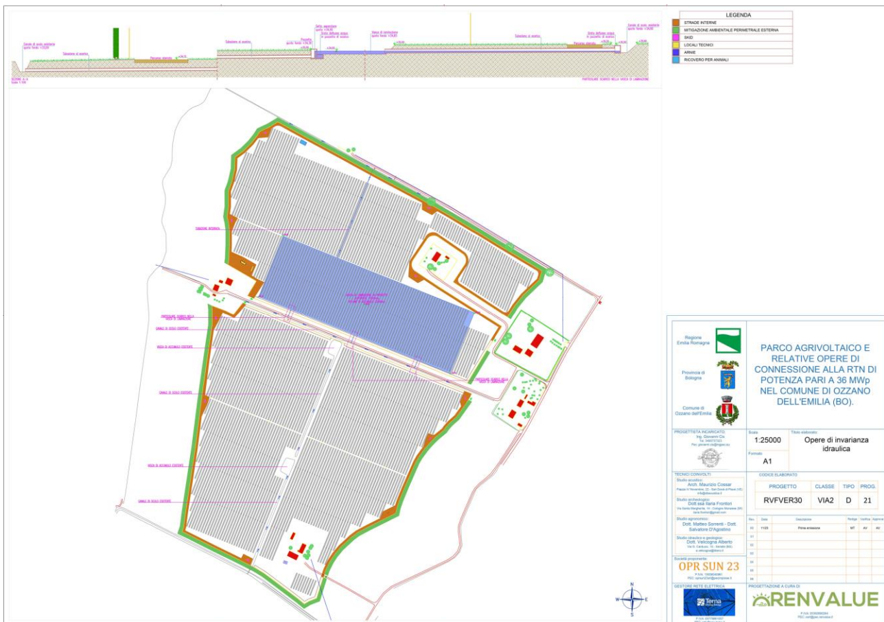
Fig. 2: planimetria e sezione di progetto del parco agrivoltaico e delle opere di invarianza idraulica.
