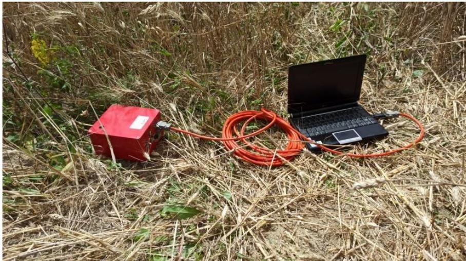
**Foto 2** – prove sismiche H.V.S.R.
