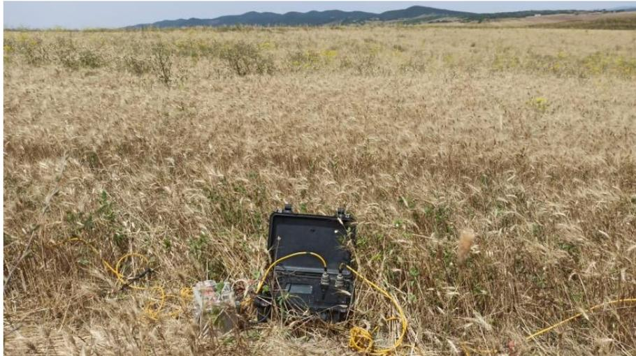
**Foto 1** – prove sismiche M.A.S.W.
