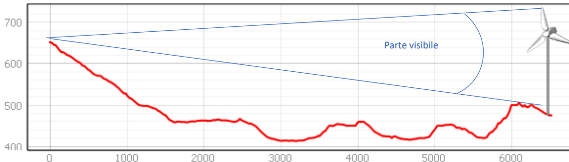
Figura 72 - Profilo tracciato dal punto di vista IMG_7326, verso l'aerogeneratore più vicino
