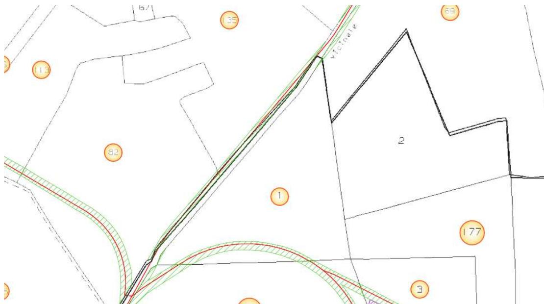
*Figura 2 - Interferenza cavidotto su particella 1 del foglio 25 del comune di Caltagirone*
