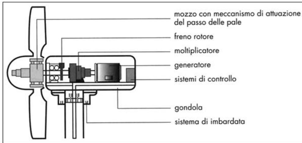
*Figura 41 - Schema di principio di un aerogeneratore*
