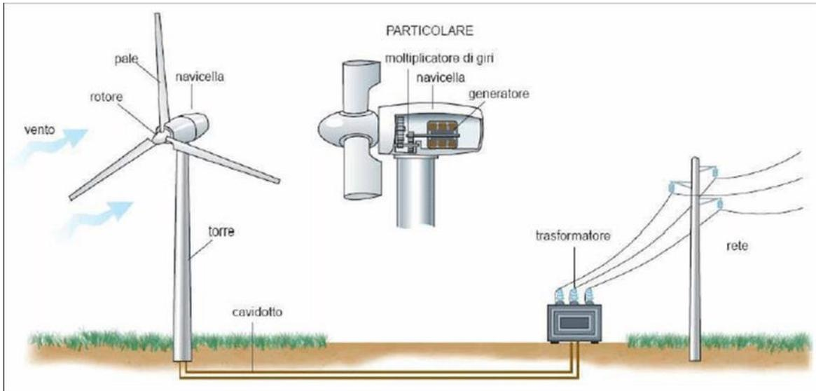
Figura 1 - Schematizzazione impianto eolico
