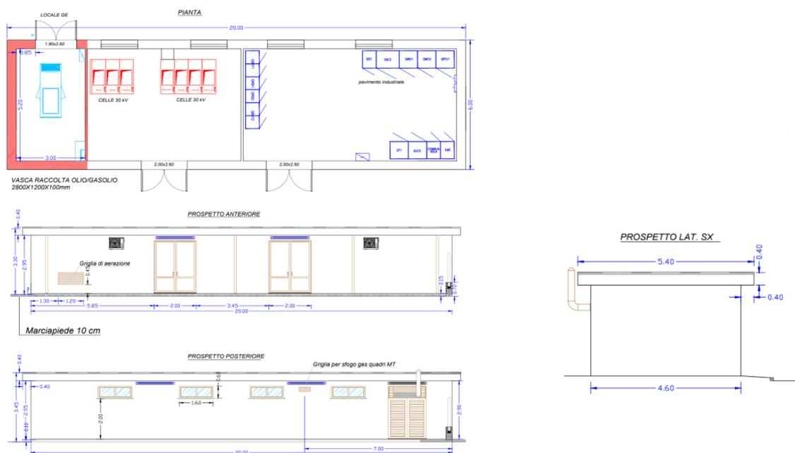
*Figura 45 - Tipico Cabina di Raccolta e Smistamento*
