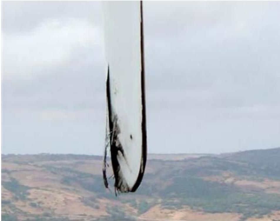
*Figura 5 - Estremità di pala danneggiata da fulminazione atmosferica*
