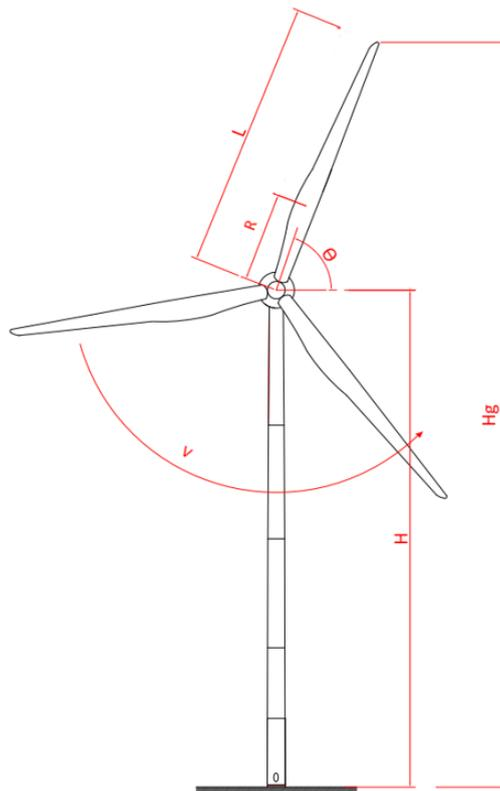
Figura 12 - Rappresentazione grafica rottura
