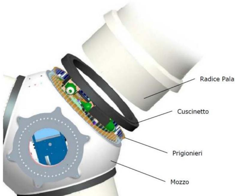
Figura 8 - Dettagli dell'attacco di una pala al mozzo
