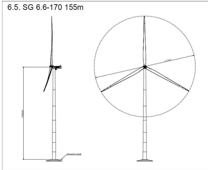
**Figura 6 - Turbina SG 6.6-170 -MOD 6,6 MW**
