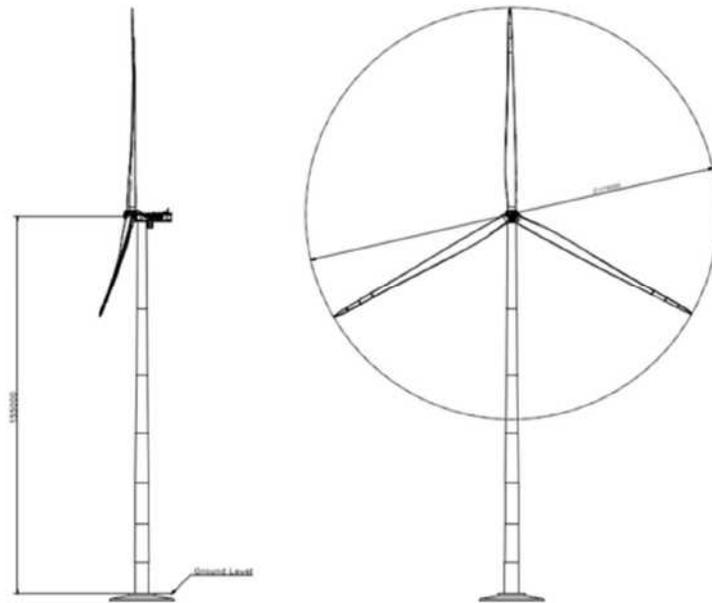
**Figura 2- Turbina SG 6.6-170 -MOD 6,6 MW**
