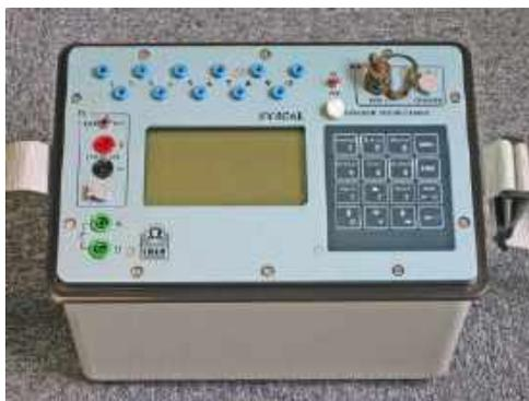
Fig. 2.3: Georesistivimetro IRIS Syscal Pro a 96 canali
