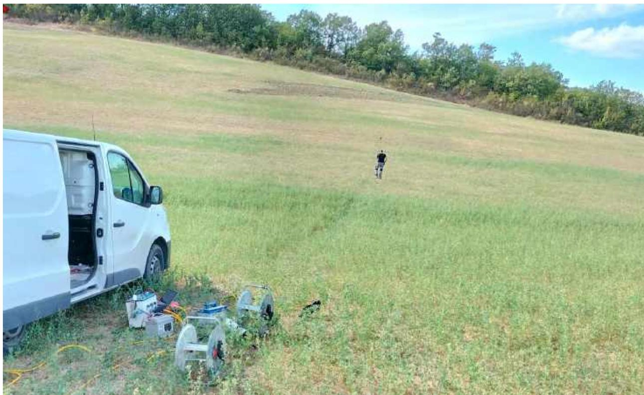
*Fig. 1.3: Particolare postazione acquisizione dati sezione sismica con spaziatura 5 m e rilievo topografico*
