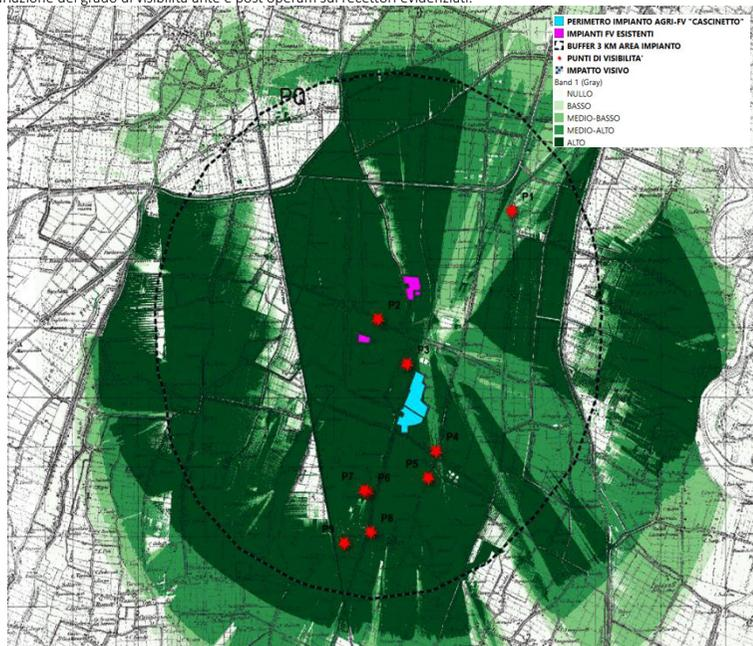
Mappa di intersvisibilità impianti fotovoltaici esistenti e previsto impianto agrivoltaico "CASCINETTO" (ante operam)
