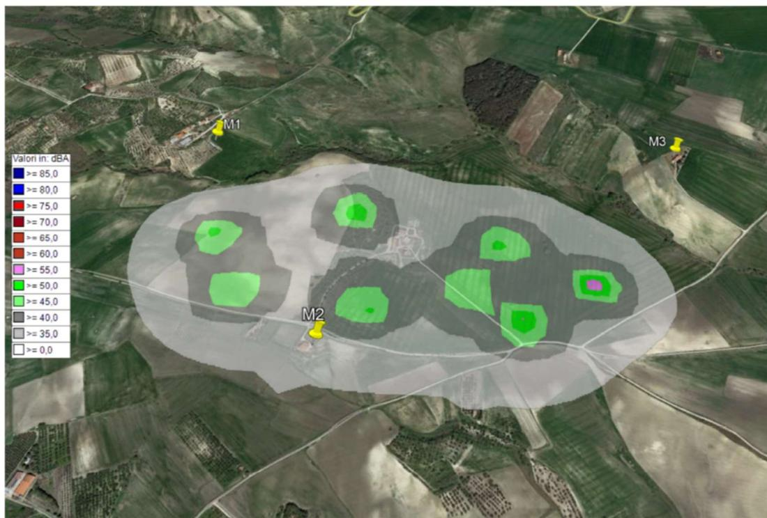
**Fig. 38 - Risultato dello studio modellistico in fase di cantiere**
