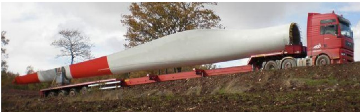
Figura 3. Mezzi per il trasporto della pala.
