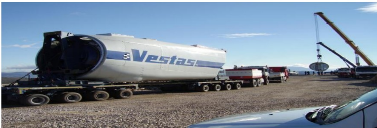
Figura 4. Mezzi per il trasporto della navicella.
