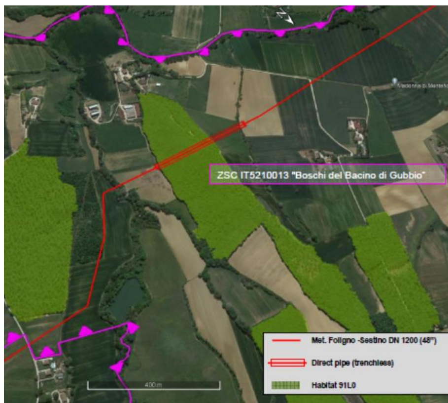
Figura 1 - Particolare attraversamento dell'area boscata (habitat 91L0) con tecnologia trenchless
