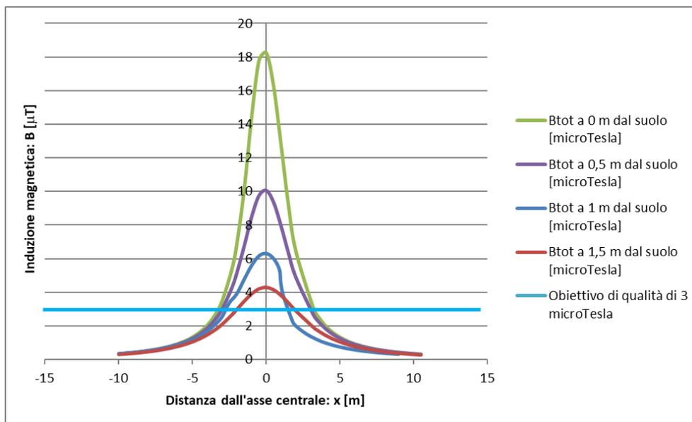
Figura 3: Andamento del campo magnetico generato dal cavidotto, composto da sei terne da 630 mm<sup>2</sup>
